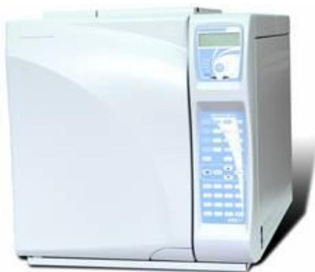
с дозатором равновесного пара для анализа ароматических углеводородов (стирола, толуола, бензола и др.), летучих галогенорганических соединений (хлороформа, четыреххлористого углерода, 1,2-дихлорэтана и др.), пестицидов в воде, почве, отходах производства и пищевых продуктах.
