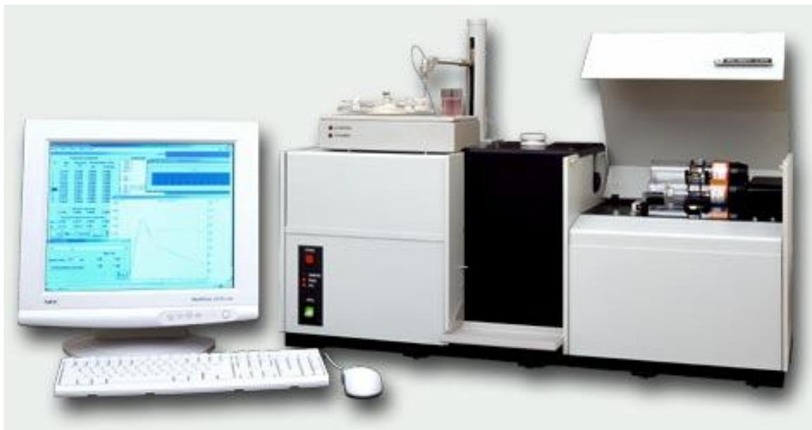
Атомно-абсорбционный спектрометр КВАНТ-Z.ЭТА предназначен для количественного определения элементов (Al, Cu, Ni, Ba, Co, Cr, Fe, Mn, Zn, Cd, Ag, Pb, As, Sr, Te, Tl, Hg) в воде, воздухе, почве, отходах производства и пищевых продуктах на уровне долей нг/л (ppt).
