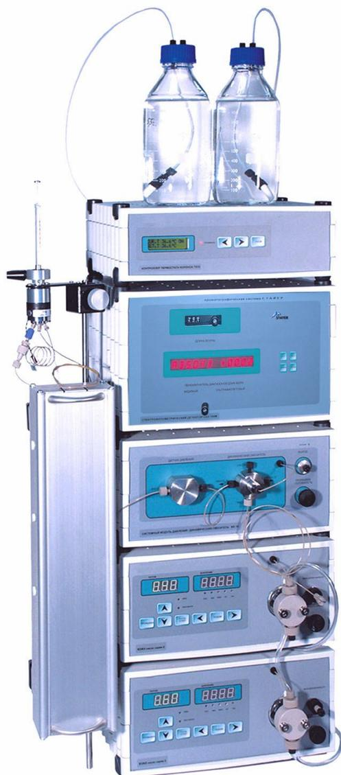
с флуориметрическим и спектрофотометрическим детекторами для определения полициклических ароматических углеводородов (бенз(а)пирена, нафталина, пирена, антрацена и др.) в воде, воздухе, почве, отходах производства и продуктах питания
