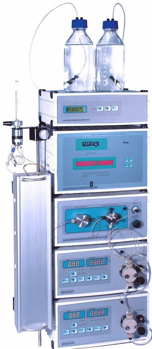
с флуориметрическим и спектрофотометрическим детекторами для определения полициклических ароматических углеводородов (бенз(а)пирена, нафталина, пирена, антрацена и др.) в воде, воздухе, почве, отходах производства и продуктах питания
