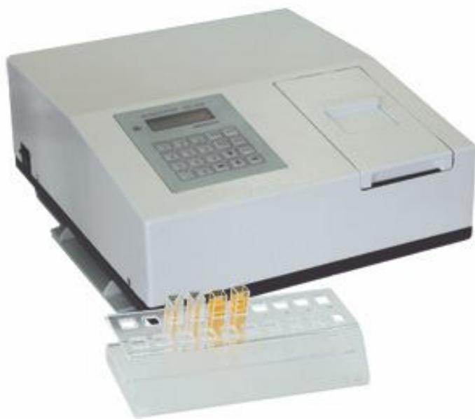
Фильтровый флуориметр «ФЛЮОРАТ<sup>®</sup>-02-2М» используется при выполнении рутинных измерений объектов, для которых предварительно установлены спектральные характеристики люминесценции.
