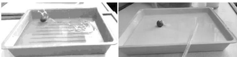
Рис. 1. Погружение стального шарика в процессе движения вдоль поверхности «ньютоновской» (слева) и «неньютоновской» (справа) жидкостей.
